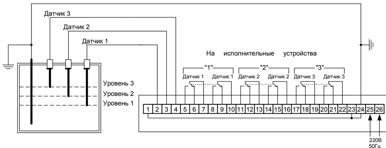
Вариант схемы подключения прибора для резервуара из непроводящего материала
