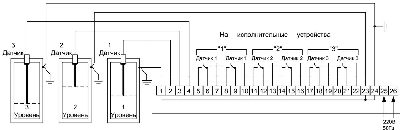
Вариант схемы подключения прибора для металлических резервуаров
